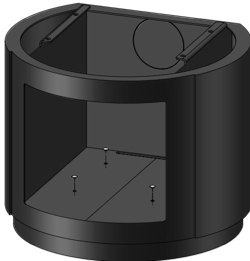
Het gemonteerde railsysteem wordt dan bevestigd zoals wordt weergegeven op de tekening met behulp van de 4 bijgeleverde nr. M6X10 binnenzeskantschroeven.
