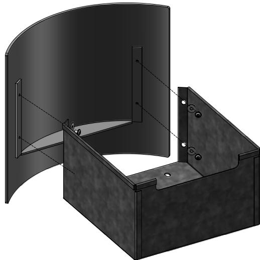
El cajón se atornilla a la cara superior del sistema de carril con los 4 tornillos de cabeza esférica con pestaña M6x8 suministrados. Para finalizar, la altura del frontal del cajón se centra en relación con la posición de la sección de pedestal y se atornilla al propio cajón.
