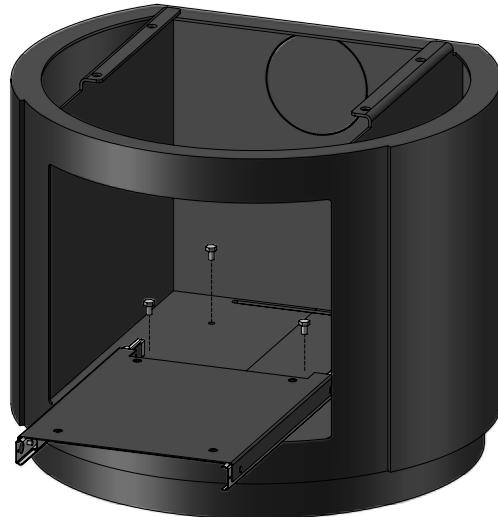
De lade wordt losjes bevestigd aan de voorkant van de lade met 4 nr. sluitringen en M6x8 binnenzeskantschroeven.
