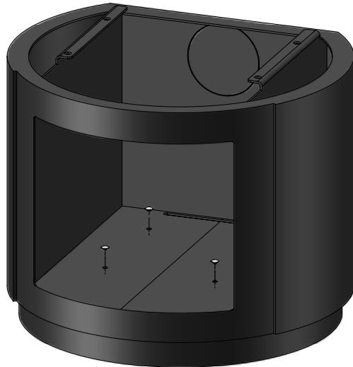
El sistema de carril ya ensamblado se instala después en su lugar como se muestra en el esquema utilizando los 4 tornillos hexagonales M6x10 suministrados.
