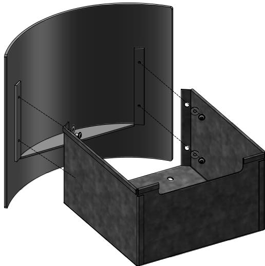
De lade wordt vastgeschroefd aan de bovenkant van het railsysteem met de 4 bijgeleverde nr. M6x8 flensbinnenzeskantschroeven. Ten slotte wordt de hoogte van de voorkant van de lade gecentreerd in verhouding tot de positie van het plintgedeelte en vastgeschroefd op de lade.
