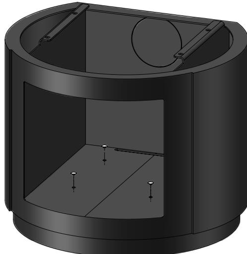
Hier zuerst das zusammengebaute Schienensystem, wie in der Abbildung gezeigt, mit den mitgelieferten vier M6X10-Sechskantschrauben montieren.
