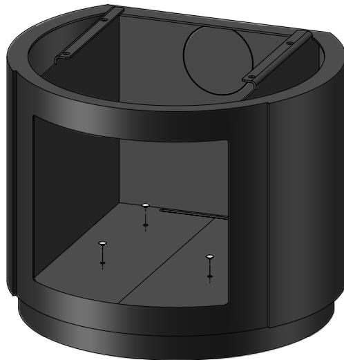
Successivamente, è necessario installare le guide scorrevoli, come illustrato nello schema; il fissaggio deve essere effettuato mediante le 4 viti esagonali M6X10 fornite in dotazione.
