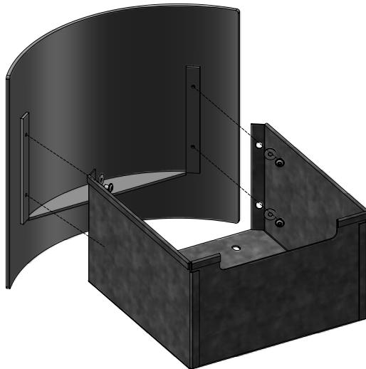
Skuffen fastskrues på oversiden af skinnesystemet med de medfølgende 4 stk. M6X8 Button-head skruer med flange. Til sidst centrereres skuffefronten også højdemæssigt i forhold til placering i sokkelsektionen og fastskrues skuffen.
