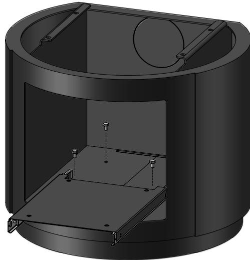
El cajón se instala sin apretar en el frontal del cajón con las 4 arandelas y tornillos M6x8 de cabeza esférica.
