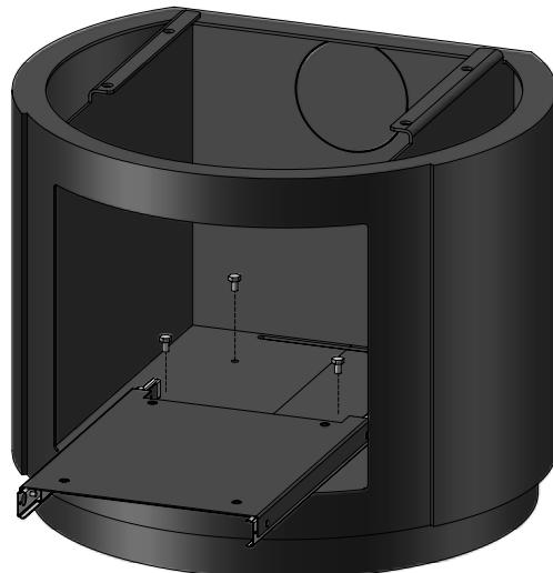
Die Schublade lose mit der Schubladenvorderseite mit vier Scheiben und M6x8-Halbrundkopfschrauben lose zusammenbauen.
