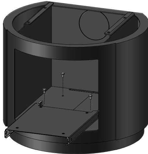
Montera lådan löst med lådfronten med fyra brickor och M6x8 skruvar med rundat huvud.
