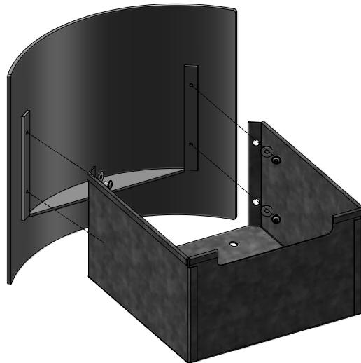
Skruta fast lådan på den övre sidan av skensystemet med de fyra medföljande M6x8 skruvarna med rundat huvud och fläns. Centrera slutligen lådfronten på höjden i förhållande till placeringen av sockelsektionen och skruva fast lådan.
