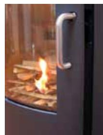
4. Når du (etter 5–10 min) kan se at skorsteinen er så varm at det er trekk gjennom den, lukker du døren helt. Hvis alle forutsetninger er oppfylt, vil det etter ytterligere 15–20 min. være dannet et godt glødelag i brennkammeret.
